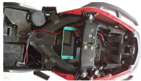
Figure 1 : EMMAPhone installé dans un 2RM
