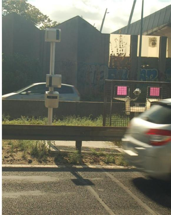
**Figure 1 : A droite, acquisition d'images par la caméra infrarouge proche lors du test sur A86. A gauche, poteau avec les capteurs lasers pour la classification des véhicules.**
